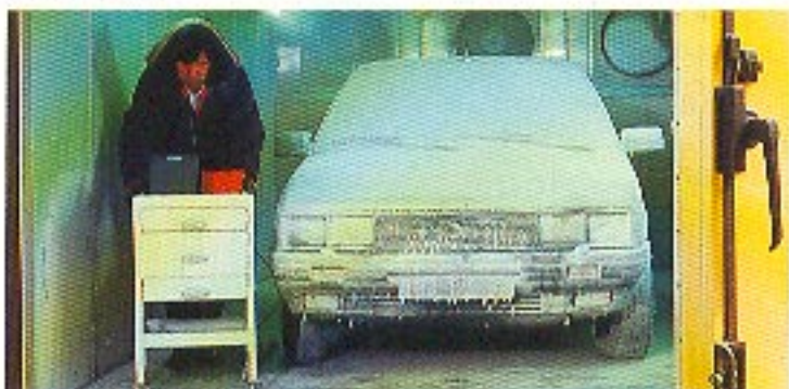
Contrôle de la montée en température du chauffage, en chambre climatique
