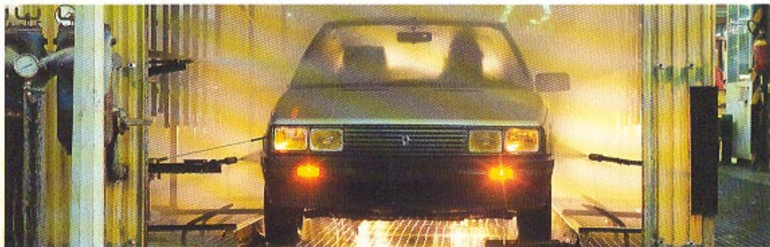
Essais en tunnel, sous conditions de pluie intense.
