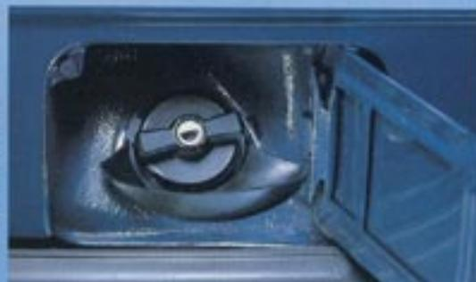
*Bouchon de réservoir à clé*
