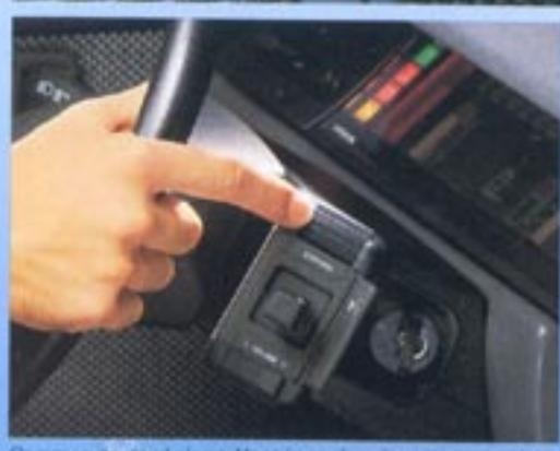
Commande de réglage électrique des miroirs extérieurs
