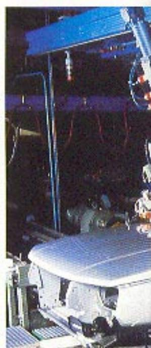
*Opération de pose par robot d'un pare-brise sur une Renault 25*
