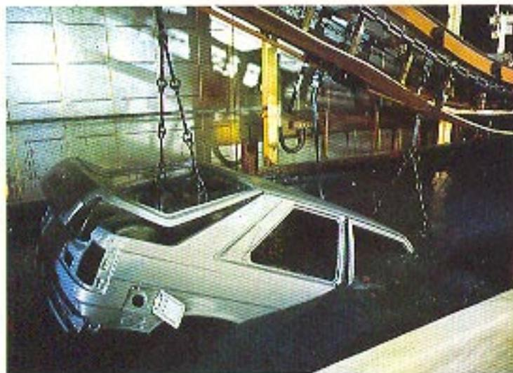
traitement de surface, contrôle de la phosphatation au zinc et, après cataphorèse, contrôle d'épaisseur, au micron près, de la couche de protection.
