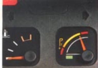
Température d'eau, niveau d'huile et témoin mini de carburant
